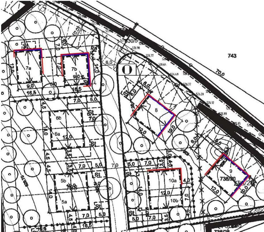
Abbildung: Lageplan mit Kennzeichnung der Fassadenbereiche im Erdgeschoss und Obergeschoss, an denen Schallschutzmaßnahmen erforderlich sind.
