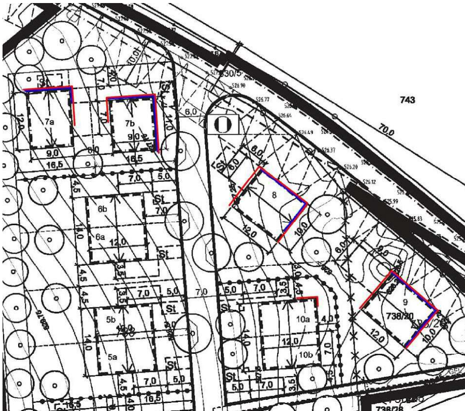
Abbildung: Lageplan mit Kennzeichnung der Fassaden, an denen Außenwohnbereiche im Erdgeschoss und Obergeschoss geschützt werden müssen.
